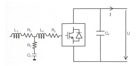
**Figure 2** Schéma électrique par phase du convertisseur. L<sub>t</sub>, R<sub>t</sub>: inductance et résistance de courtcircuit par phase du transformateur. R<sub>f</sub>, C<sub>f</sub>: résistance et condensateur du filtre d'harmoniques. L<sub>c</sub>, R<sub>c</sub>: inductance et résistance de lissage.
