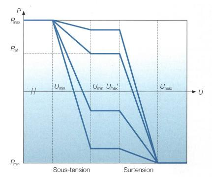
Figure 3 Caractéristiques de commande P-U.
