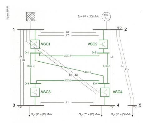
**Figure 4** Topographie du réseau combiné. MS3: générateur synchrone; L1 à L10: lignes AC; LDC-1 à LDC-5: lignes HVDC; VSC1 à VSC4: convertisseurs; 1 à 5: nœuds AC (60 kV nom.); D1 à D4: nœuds DC (94 kV nom.).
