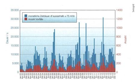
**Bild 1** Dauer und Anzahl der Frequenzabweichungen ausserhalb  $\pm$  75 mHz.
