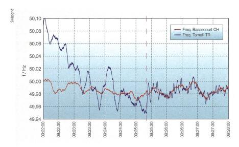
Bild 11 Zusammenschaltung des europäischen Netzes mit der Türkei am 18. September 2010.
