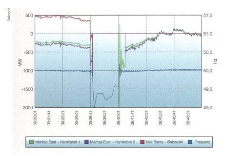
Bild 16 Wirkleistungsflüsse während des Inselnetzbetriebs der Türkei vom 30.11.2011.
