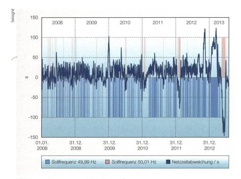
**Bild 7** Netzzeitabweichung und Einstellung Sollfrequenz.
