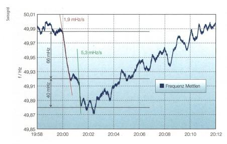
**Bild 4** Deterministische Frequenzabweichung mit anschliessendem Ausfall eines Kraftwerks (1400 MW), Februar 2013.
