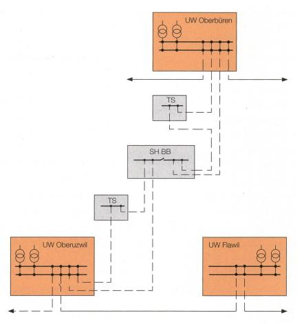
Bild 1 Zielnetzvariante 1: Versorgung über drei bestehende Unterwerke.
