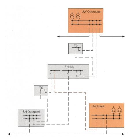
Bild 2 Zielnetzvariante 2: Versorgung über zwei Unterwerke.
