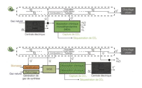
**Figure 3** Options comparées pour la capture de CO<sub>2</sub> dans des centrales électriques: a) la postcombustion et b) la précombustion.
