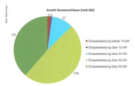
**Bild 4** Das Softwaretool erlaubt es, für ein gesamtes Niederspannungsnetz die maximal mögliche Einspeiseleistung pro Hausanschluss zu ermitteln, unter Berücksichtigung bestehender Erzeugungsanlagen. Bei 256 Hausanschlüssen darf über 20 kW Leistung ins Netz eingespiesen werden.
