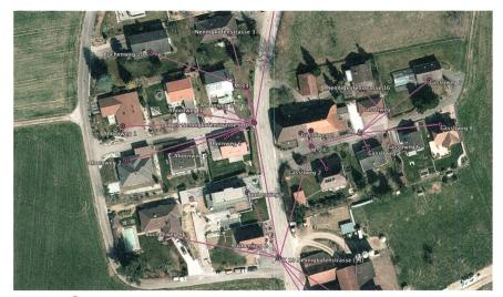
**Bild 1** Die Überlagerung der Netzdaten mit Google Earth zeigt: Für die grafische Darstellung verzichtet die Schnittstelle auf den Export von zahlreichen geografischen Informationen. So werden nur Punktobjekte wie Verteilkabinen, Muffen oder Hausanschlüsse geografisch lagerichtig abgebildet. Leitungen verbinden diese Punktobjekte als direkte Linie ohne geografischen Bezug.
