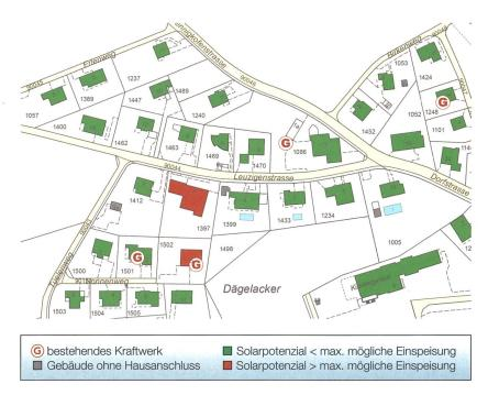
**Bild 3** Grafische Darstellung der Gebäude, die aktuell die gesamte Dachfläche für die Solarstromproduktion ausnutzen können. Bei grünen Gebäuden ist das Solarpotenzial kleiner als die maximal mögliche Einspeiseleistung.
