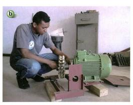
Figure 4 Construction de la pico-turbine Pelton à l'atelier malgache de l'ONG.
