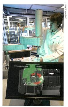
Optische Arbeitsraumüberwachung für einen Roboter am Fraunhofer IFF.
