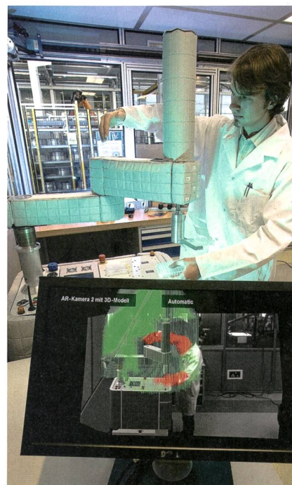
Optische Arbeitsraumüberwachung für einen Roboter am Fraunhofer IFF.
