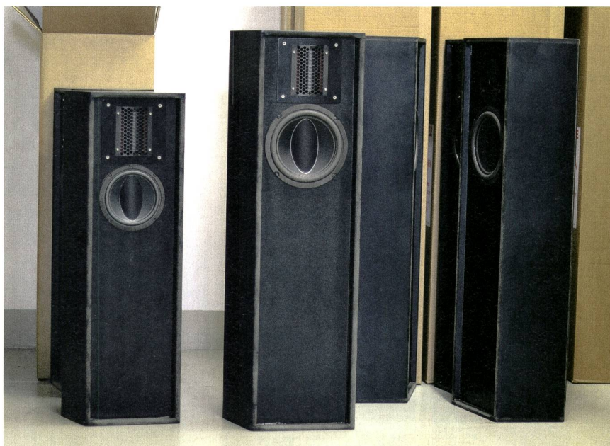
Bild 1 Bipol-Standlautsprecher von Rowen ohne Stoffbespannung. Oben sieht man den für den Hoch- und Mitteltonbereich zuständigen Linear Motion Transformer, darunter den Bassstreiber.
