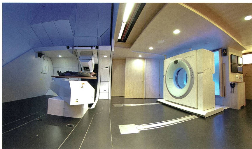
Bild 3 Bestrahlungsgerät «Gantry 2» am PSI: In der linken Bildhälfte ist die drehbare Gantry mit Bestrahlungskopf und Patientenliege zu sehen, rechts im Bild ein CT-Scanner, der für die Bestrahlungsplanung und zur genauen Positionierung eingesetzt wird. (Die abgebildete Person ist kein Patient.)
