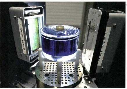
**Bild 5** Testanordnung von 2 AX-PET-Detektoren (aussen) und einem Phantom (Mitte), mit dem sich die Eigenschaften der Detektoren testen lassen.
