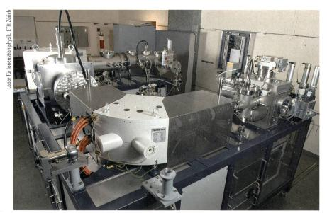
Bild 6 Massenspektrometer BioMICADAS des Labors für Ionenstrahlphysik der ETH Zürich. Die Ionen werden in der Ionenquelle (rechts) erzeugt, beschleunigt und abgelenkt (linke Bildhälfte). Das <sup>14</sup>C wird dann in einem Detektor (Mitte oben) gemessen.
