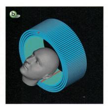
**Bild 4** (a) Radiale (klassische) Anordnung der Szintillatoren und (b) neue, axiale Anordnung der Szintillatoren in einem PET-Gerät.
