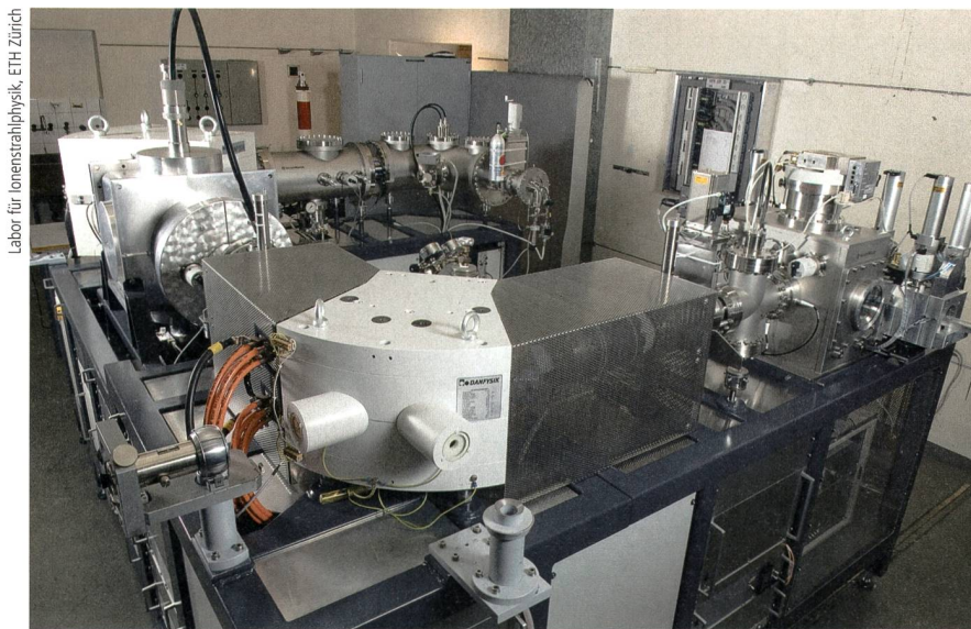
Bild 6 Massenspektrometer BioMICADAS des Labors für Ionenstrahlphysik der ETH Zürich. Die Ionen werden in der Ionenquelle (rechts) erzeugt, beschleunigt und abgelenkt (linke Bildhälfte). Das ^{14}\text{C} wird dann in einem Detektor (Mitte oben) gemessen.
