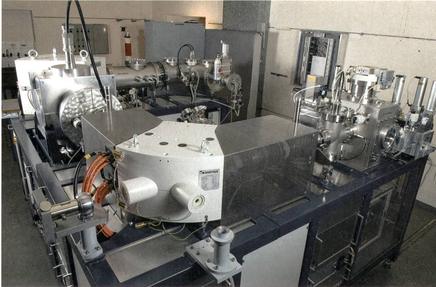
Bild 6 Massenspektrometer BiOMICADAS des Labors für Ionenstrahlphysik der ETH Zürich. Die Ionen werden in der Ionenquelle (rechts) erzeugt, beschleunigt und abgelenkt (linke Bildhälfte). Das ^{14}\text{C} wird dann in einem Detektor (Mitte oben) gemessen.
