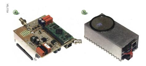
Figure 6 Démonstrateur : émetteur (a) et récepteur (b).
