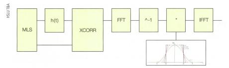
Figure 4 Calcul des coefficients du filtre FIR.
