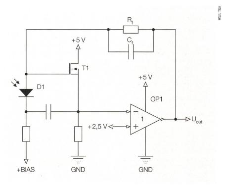
Figure 5 Schéma de l'amplificateur du récepteur.
