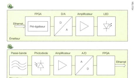
Figure 1 Système de transmission : schéma bloc de l'émetteur (a) et du récepteur (b).
