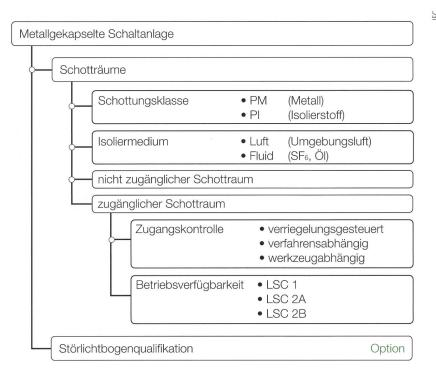
Bild 1 Klassifizierungsstruktur von metallgekapselten Schaltanlagen nach IEC 62 271-200.
