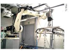
Pantografen-Prüfstand an der TU Wien.
