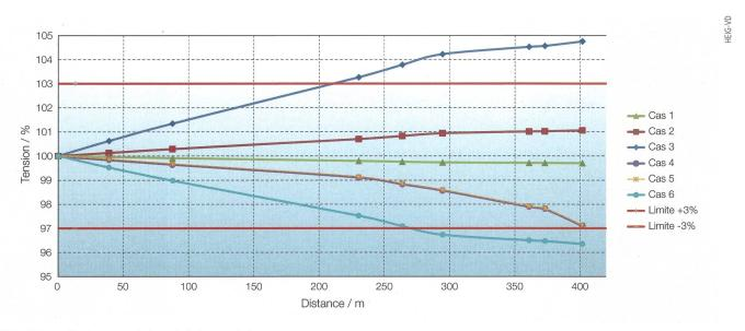
Figure 2 Profils de tension le long de la ligne radiale.
