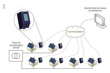
Figure 3 Communication sur une ligne BT avec le module iGi.
