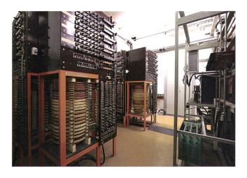
**Bild 3** Induktivitäten zur Wirkfaktorsteuerung des Prüfstroms.
