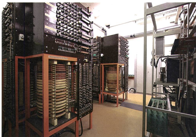
Bild 3 Induktivitäten zur Wirkfaktorsteuerung des Prüfstroms.
