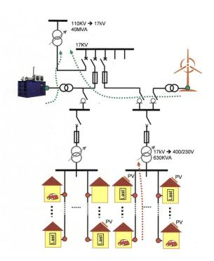
**Bild 4** Metering-Punkte im Mittelspannungs- (grün) und Niederspannungsnetz (rot) an wichtigen Einspeiseund Verbrauchermodulen.
