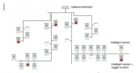
**Bild 2** Kommunikationshierarchie mit vereinzelten Sensoren, die zur Überwachung kritischer Werte dienen.
