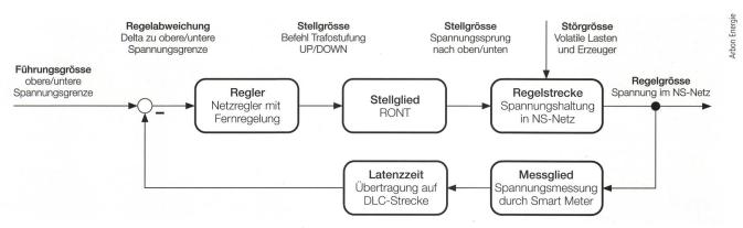
Bild 3 Schematische Darstellung des Regelkreises mit Spannungsmessung in Haushalten durch Smart Meter.
