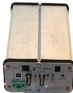
Bild 5 Ormazabal API-2000-SA MV-BPL Modem.
