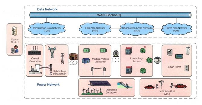
Bild 1 Smart-Grid-Stromverteilungs- und Daten-Netz-Architektur.
