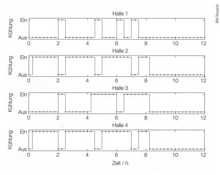
Bild 7 Optimaler Kühlfahrplan für 4 Kühlhallen.
