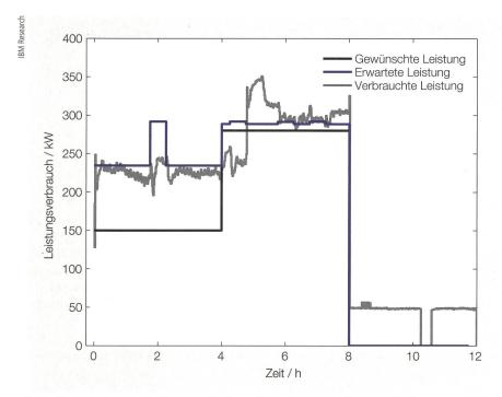
**Bild 6** Vergleich zwischen gewünschtem, erwartetem und realisiertem Leistungsverbrauch.
