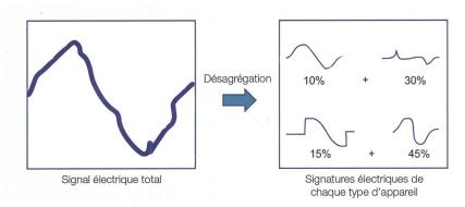
**Figure 3** Les algorithmes mis en oeuvre par Smart Impulse permettent de retrouver la part des consommations propre à chaque type d'appareil.
