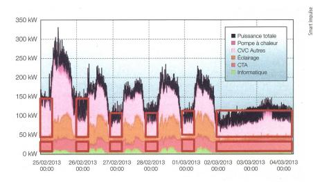
**Figure 4** Une régulation des centrales de traitement de l'air et des autres équipements de chauffage, ventilation, climatisation (CVC) la nuit et le week-end permettrait d'obtenir un gain de 25 % sur les consommations.
