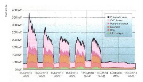
**Figure 5** Courbe de charge sur une semaine après modification des paramètres de consignes des systèmes de gestion des équipements.
