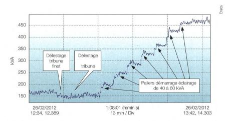
Figure 1 Analyse des courbes de charges mises à disposition par les distributeurs.
