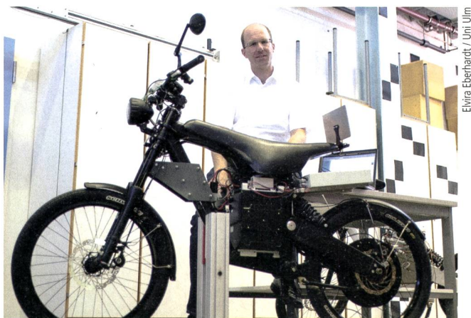
Der Ulmer Ingenieur Dr. Buchholz mit einem Testfahrzeug. Ein Allradantrieb soll das Elektrokraftfahrzeug sicherer und spritziger machen.
