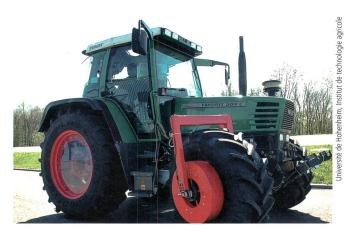
Un tracteur d'essai équipé de jantes de mesure spéciales qui permettent d'absorber les forces générées pendant la conduite.
