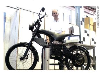
Der Ulmer Ingenieur Dr. Buchholz mit einem Testfahrzeug. Ein Allradantrieb soll das Elektrokraftrad sicherer und spritziger machen.
