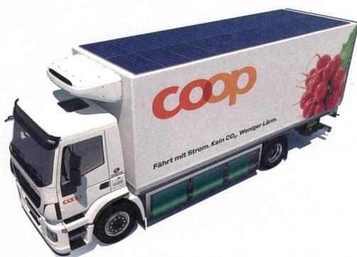
Das Kühlaggregat des E-Force wird über Solarmodule auf dem Dach des E-LKW gespiesen.
