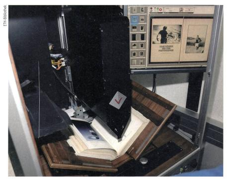
**Bild 4** Scan-Roboter im Digicenter der ETH-Bibliothek. Um den Buchrücken zu schonen, wird das Buch nicht vollständig aufgeklappt. Im Scankopf befinden sich zwei Kameras, mit denen zwei Seiten gleichzeitig gescannt werden können.
