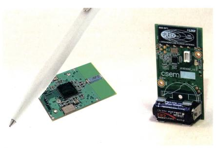
Figure 1 Exemples de nœuds d'un réseau de capteurs sans fil réalisés au CSEM.
