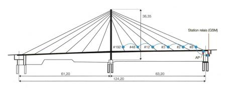
Figure 4 Propagation des informations de nœud en nœud sur un pont haubané.
