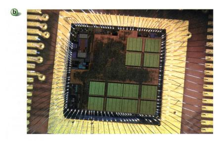
**Figure 2** Représentation schématique d'un nœud de réseau de capteurs et actionneurs sans fil (a) et photo d'un circuit intégré du CSEM implantant les fonctions indiquées (b).
