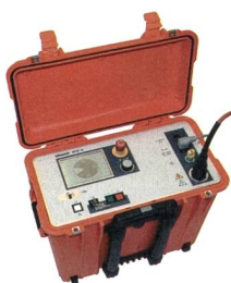
Die Vorortung mit der Spannungsabfallmethode ist möglich.
