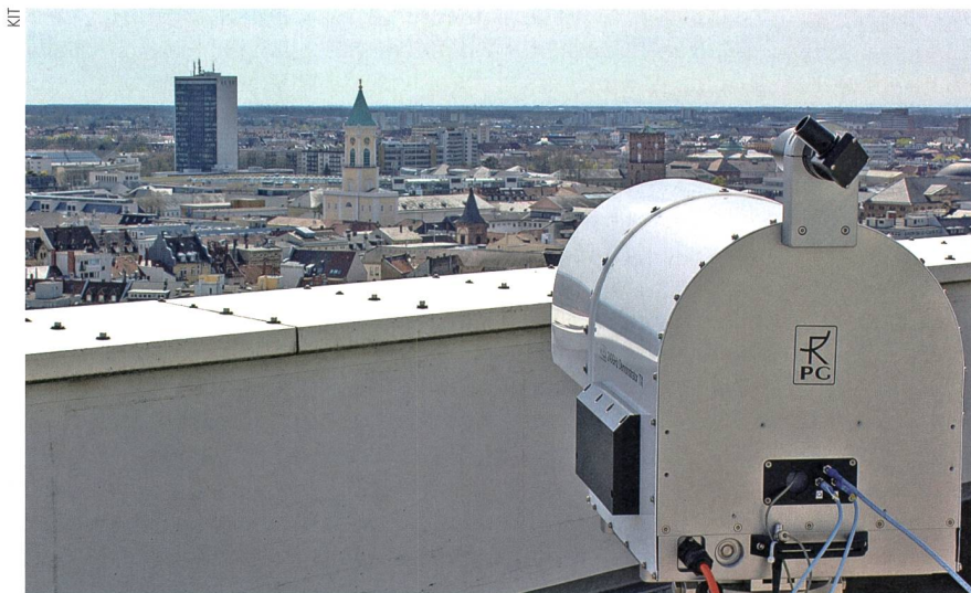
Mit einem Langstreckendemonstrator zwischen zwei Hochhäusern in Karlsruhe konnte bereits eine Distanz von über 1 km überbrückt werden.
