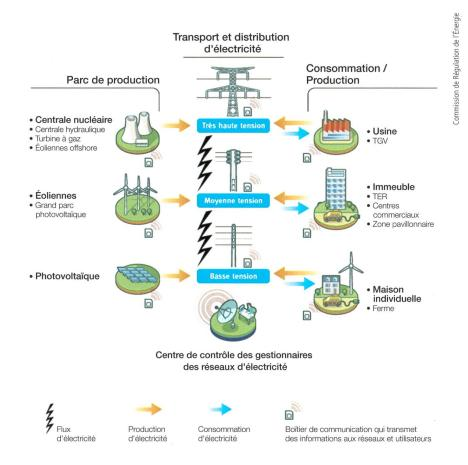
Figure 1 Structure d'un smart grid.
