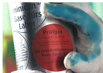
Der Sensorhandschuh färbt sich in Gegenwart eines Gefahrstoffs blau.
