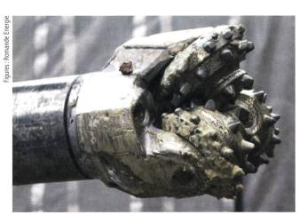
La tête de forage est équipée à son extrémité d'une tête d'usure adaptée à la nature du terrain. Elle est également munie de buses d'injection d'eau ou de boue de forage.
