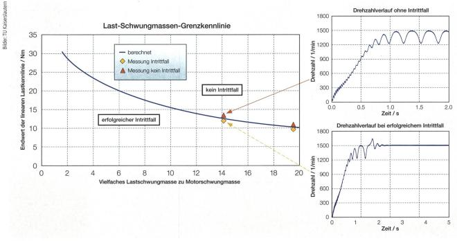
Bild 4 Intrittfallgrenze des Funktionmusters für den Kaltstart und Bemessungsspannung 400V/50 Hz bei linearer Lastkennlinie.
