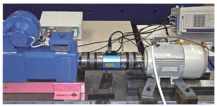
**Bild 2** Versuchsaufbau zur Erprobung des Funktionsmusters mit der Lastmaschine (links), dem Prüfling und der dazwischenliegenden Drehmomentmesswelle.
