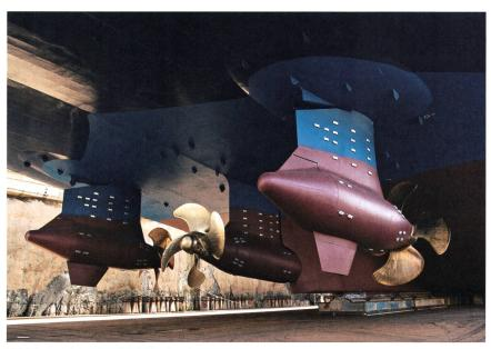
**Bild 2** Drei Azipods mit Schiffsschrauben.
