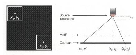
Figure 5 Combinaison de 2 zones (mesures à 2 DDL) et triangulation pour une mesure à 3 DDL.
