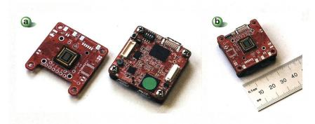
Figure 6 Capteur d'image et module de traitement embarqué, avant (a) et après l'assemblage (b).
