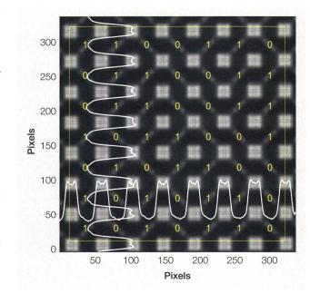
Figure 4 Un motif de cadran 2D: la position absolue est codée par l'orientation des barres diagonales et le réseau régulier facilite la mesure de position à haute résolution à l'intérieur d'une période de code.
