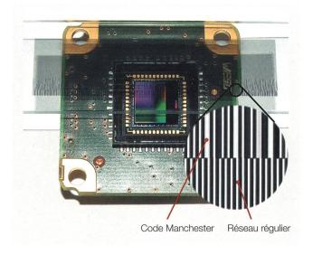
Figure 2 Configuration d'imagerie par projection d'ombre composée d'une caméra USB compacte et d'une réglette transparente.
