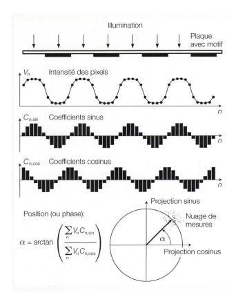
**Figure 3** Schéma d'un principe de mesure de position robuste et de haute précision.
