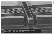
Rasterelektronenmikroskop-Aufnahme des Nanokraftsensors.
