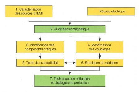
Figure 1 Les différentes phases du projet.
