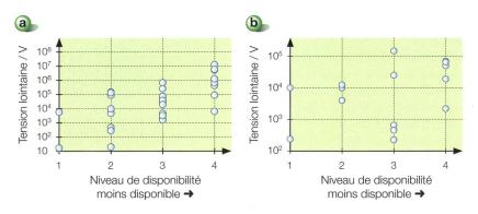
**Figure 3** Tension lointaine (champ électrique à une distance générique de 1 m) en fonction de la disponibilité: (a) couplage rayonné, (b) couplage conduit.
