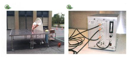
Figure 2 Exemples de sources d'interférences : (a) rayonnée et (b) conduite.
