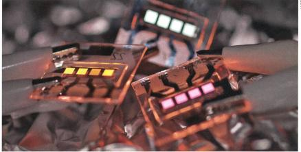
Les LED organiques sont des sources lumineuses planes également susceptibles d'être appliquées sur des substrats flexibles.
