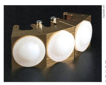
Das W-Band-Radar ist mit einer breitbandigen 3-Kanal-Antenne mit dielektrischen Linsen ausgestattet.
