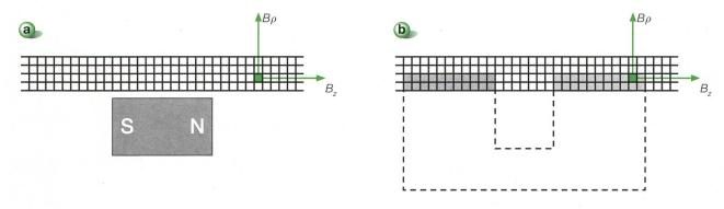
Bild 6 Betrachtung der magnetischen Flussdichte: a) über einem Permanentmagneten; b) im Leiterbereich einer Doppelspule.
