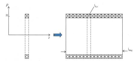
**Bild 5** Ringstrom und Überlagerung zur Nachbildung eines Permanentmagneten.
