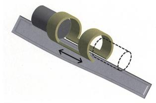
Bild 1 Grundprinzip des Doppelspulenaktors.
