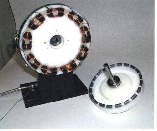
Bild 8 Komponenten eines 20-poligen Funktionsmusters.
