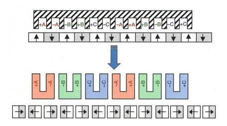
**Bild 3** Bildung einer überlappungsfreien 3-strängigen Doppelspulenanordnung in Analogie zu einer Einschicht-Zahnspulenwicklung der Ständernutenzahl N = 12 und der Polzahl 2p = 10.
