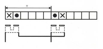
**Bild 2** Überleitung von der Einschicht-Zahnspulenwicklung zur Doppelspulenanordnung am Beispiel der Ständernutenzahl N=12 und der Polzahl 2p=10.
