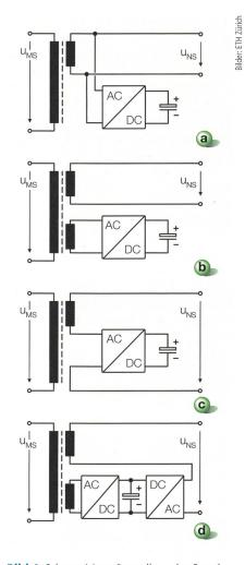
**Bild 4** Schematisierte Darstellung der Grundkonzepte hybrider Verteiltransformatoren.
