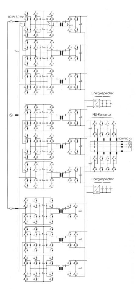
Bild 2 Leistungsteil eines Solid-State-Verteiltransformators (SST).
