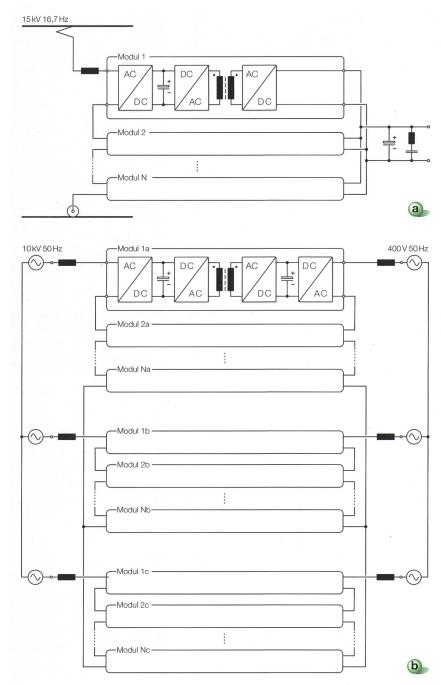
**Bild 1** Einsatz von Solid-State-Transformatoren für Triebfahrzeuge (a) oder Netzkopplung (b).
