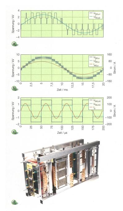
**Bild 3** Spannung am Eingang eines AC/DC-Konvertermoduls und Spannungs- und Stromverlauf eines Phasenzweiges des SST sowie eines DC/DC-Konvertermoduls.
