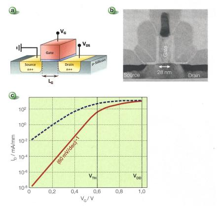
**Bild 1** Der konventionelle MOSFET. a) Schematischer Aufbau eines MOSFETs. b) MOSFET-Transfercharakteristik mit (blaue Kurve) und ohne Kurzkanaleffekte (rote Kurve). c) MOSFET in heutigen Schaltkreisen mit 28 nm Gate-Länge.
