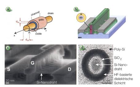
**Bild 3** Si-Nanodraht-MOSFET. a) Schematisches Bild eines Nanodrahts mit Gate-Elektrode und Gate-Oxidschicht, welche den Nanodraht voll umschliessen. b) Schema eines MOSFETs auf der Basis lateraler Nanodrähte. c) Rasterelektronenmikroskopieaufnahme eines Si-Nanodraht-MOSFETs. d) Transmissionselektronenmikroskopaufnahme des Querschnitts eines Nanodrahts. (Reproduziert aus [5].)
