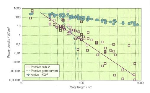
**Bild 2** Herausforderungen der Skalierung. Aktive und passive Leistungsdichte als Funktion der Gate-Länge; reproduziert aus [3].
