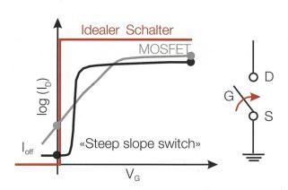
physikalische Grenze von 60 mV/dec der inversen Steigung der Einschaltcharakteristik des MOSFETs. Diese führt zu einer Limitierung der Betriebsspannung (Bild 4). Wie erwähnt, beträgt diese minimale Spannung beim Silizium-MOSFET etwa 0,8 V.
