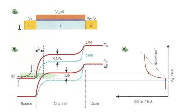
Bild 5 Funktionsprinzip eines Tunnel-FETs. a) Schematischer Ouerschnitt eines TFETs. b) Energiebandkantendiagramm des TFETs im ausgeschalteten (gestrichelte blaue Linie) und im eingeschalteten (rote Linie) Zustand. c) Schematische Zeichnung der Einschaltcharakteristik eines TFETs im Vergleich zum MOSFET. (Reproduziert aus [8].)
