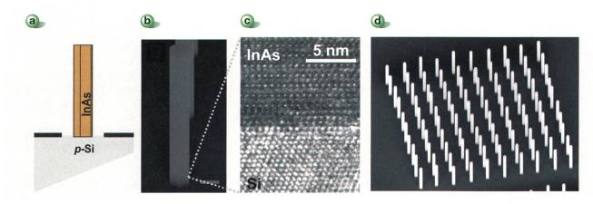
**Bild 6** Indiumarsenid-Nanodrähte. a) Schema des InAs-Nanodrahtwachstums auf einer strukturierten Si-Oberfläche. b) InAs-Nanodraht mit hexagonalem Querschnitt, gewachsen auf Si. c) Transmissionselektronenmikroskopieaufnahme der InAs-Si-Grenzfläche. d) Feld von vertikalen InAs-Nanodrähten, gewachsen auf Si.
