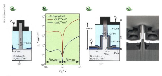
**Bild 7** Tunneldiode und Tunnel-FET. a) Schema einer InAs-Si-Heterostruktur-Nanodrahtdiode. b) Elektrische Charakteristik von InAs-Si-Nanodraht-Esaki-Tunneldioden. c) Schematischer Aufbau eines InAs-Si-Nanodraht-Tunnel-FETs. d) Rasterelektronenmikroskopaufnahme des Querschnitts eines InAs-Si-Nanodraht-Tunnel-FETs.
