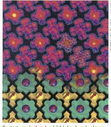
Rastertunnelmikroskopbild (oben) und schematische Darstellung der Moleküle.
