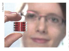
Organische Sensoren können klein- und grossflächig auf CMOS-Chips aufgebracht werden, aber auch auf Glas oder biegsame Kunststoff-Folien.
