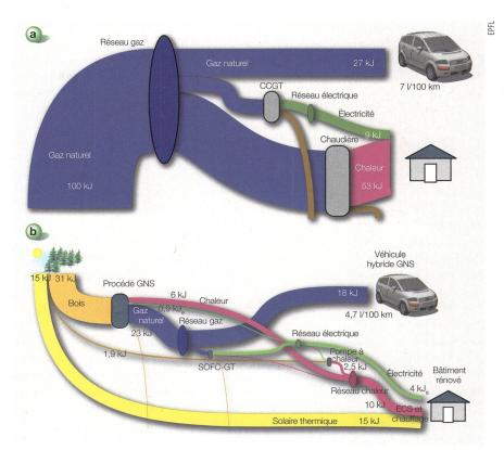
**Figure 4** Exemples de systèmes énergétiques pour un ménage : (a) système traditionnel basé sur du gaz naturel avec production d'électricité par une centrale gaz à cycle combiné (CCGT), (b) système avancé à base d'énergies renouvelables.
