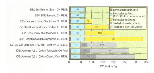
**Bild 1** Auswirkung verschiedener Stromarten: Treibhausgase pro Fahrzeugkilometer 2012. BAU: Business as usual, Com: Connected Mobility, EFF: Effizienz, ICE: Internal Combustion Engine.
