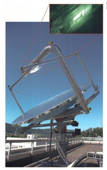
**Bild 4** Kostengünstiger Parabolkonzentrator mit Multichip-Fotovoltaik-Receiver und thermischem Receiver mit passender Apertur.
