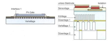
Bild 2 Querschnitt einer PV-Zelle auf einem Silizium-Mikrokanalsubstrat. Auf dem Substrat befinden sich eine Metallschicht und ein thermisches Interface (TIM) für die elektrische und thermische Kontaktierung.
