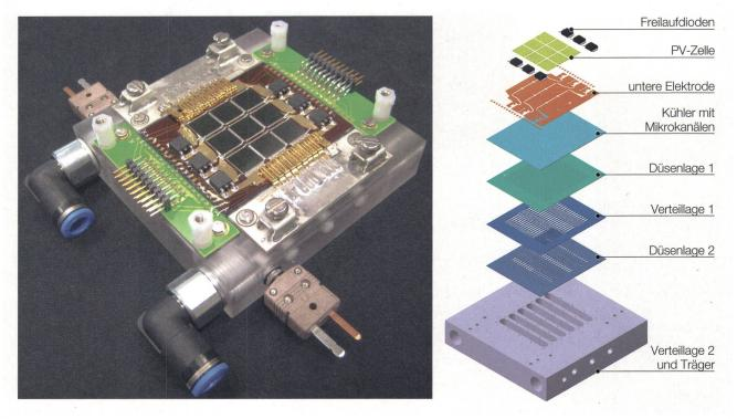
**Bild 3** Multi-Chip-Receiver (MCR) Demonstrator (links) mit schichtweisem Aufbau (rechts) aus PV-Zellen und Freilaufdioden, unterer Elektrode, Substrat im Mikrokanälen, Düsen- und Zulauf- bzw. Verteillagen.
