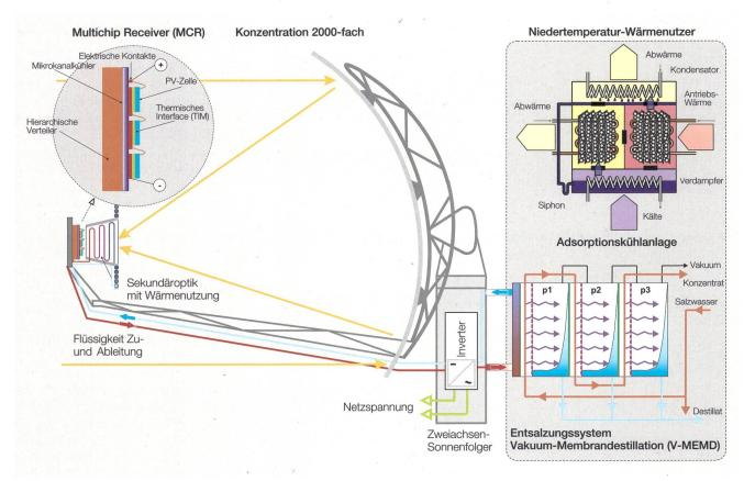
**Bild 1** Schema eines HCPVT-Systems mit Niedertemperatur-Wärmenutzung für Adsorptionskühlung (oben rechts) und Membrandestillation (unten rechts). Fotovoltaische Dreifachdioden-Zellen (3J) sind auf einem Mikrokanalkühler platziert (oben links).
