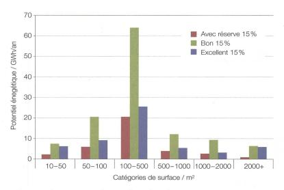
Figure 3 Potentiel énergétique en fonction des surfaces de toit (canton NE).
