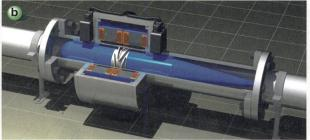
Figure 1 Vue 3D de la microturbine contrarotative avec les génératrices à l'intérieur du moyeu (a) ou sur la périphérie de la turbine (b).
