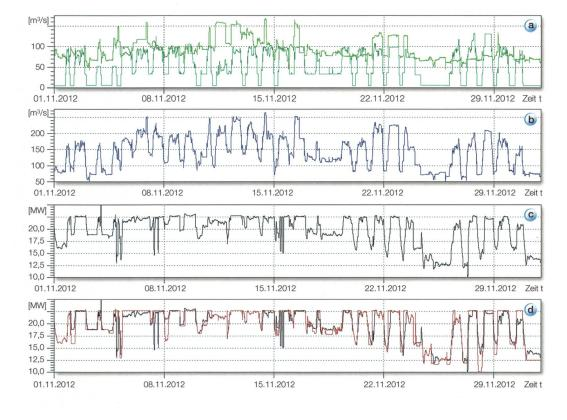
**Bild 1** Beispiel von Einflussgrössen, Produktionsprognose und tatsächlicher Produktion eines Flusskraftwerks der BKW.
