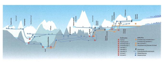
Bild 1 Anlagenschema der Kraftwerke Oberhasli.
