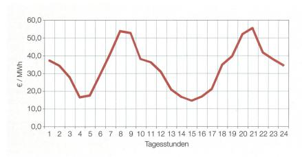
**Bild 2** Strompreisverlauf an einem Septemberwerktag 2012: Relativ hohe Preise in den Morgenund Abendstunden, am Mittag tiefe Preise durch eine grosse Solar- und gleichzeitig einsetzende Windstromproduktion.
