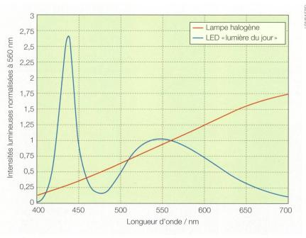
**Figure 1** Signatures spectrales d'une lampe halogène (IRC 100) et d'une lampe LED dite « lumière du jour » (IRC 67). Le pic de la LED bleue à 435 nm et la réponse jaune du phosphore centrée autour de 550 nm sont bien visibles, tout comme les déficits de la LED dans le bleu-vert et dans le rouge.
