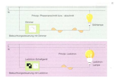
**Bild 8** Wirkprinzip von Phasendimmern und Ledotron-Steuergeräten im Vergleich.
