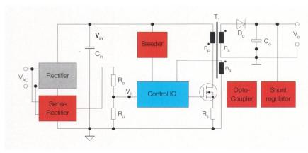
Bild 1 Prinzip eines LED-Vorschaltgerätes.
