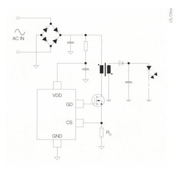
Bild 3 Einfachstes LED-Netzvorschaltgerät als Schaltungsapplikation mit hohem Leistungsfaktor ohne Dimmbarkeit (Firma LIS, Shanghai, China).
