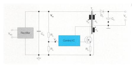
**Bild 2** Einfaches Blockschaltbild eines LED-Netzvorschaltgerätes ohne zusätzliche Funktionsblöcke unter Einhaltung eines hohen Leistungsfaktors (PF > 0,95) und Dimmbarkeit mit Phasendimmern (Bleeder nicht gezeigt).
