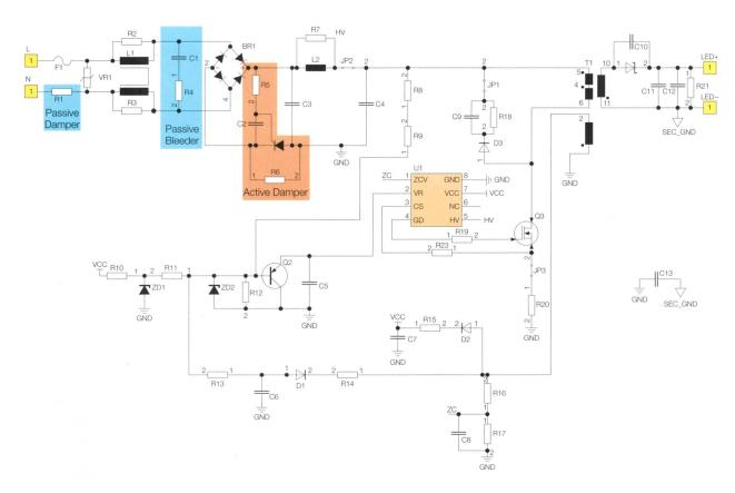
**Bild 6** Typische Applikationsschaltung eines LED-Vorschaltgerätes mit PFC und erweiterter Dimmbarkeit an Phasendimmern durch aktive und passive Dämpfung.
