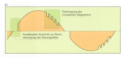
**Bild 7** Störungsarme Dimmerfunktion durch Signalübertragung auf der Netzleitung vom Steuergerät zur LED-Vorschaltelektronik nach Ledotron-Standard.
