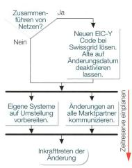
**Bild 1** Prozess bei der Zusammenführungen von Verteilnetzbetreibern und Netzen.
