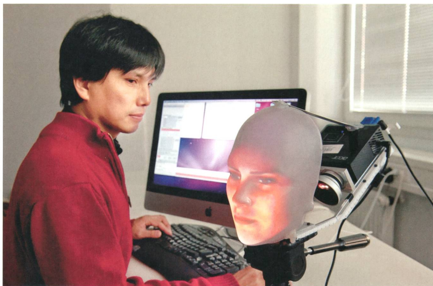
Une lentille fish eye avec un macro-adaptateur permet d'obtenir un visage complet avec une distance de seulement 12 cm entre la lentille et le masque.
