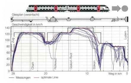
Das Strecken-Geschwindigkeitsdiagramm Zug-Luzern: Obwohl erfahrene Lokführer nach Gisikon-Root die mögliche Maximalgeschwindigkeit nicht mehr ausfahren, müssen sie vor dem eingleisigen Streckenabschnitt nach Ebikon und vor der Einfahrt in Luzern regelmässig stoppen.
