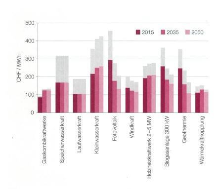
**Bild 2** Geschätzte Produktionskosten verschiedener Technologien bis zum Jahr 2050. Rot: Diskontierungszinssatz 5 %, Grau: Diskontierungszinssatz 10 % Wärmekraftkopplung: 2015: 200-kW-Blockheizkraftwerk; 2035: 400-kW-Blockheizkraftwerk; 2050: 400-kW-Brennstoffzelle
